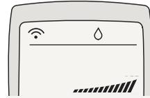
4. Nem giderme (alma) konumunda klimanız oda sıcaklığını hissederek ayar sıcaklığını ve fan hızını otomatik olarak belirleyecektir. Bu durumda sıcaklık göstergesi ekranda görülmeyeceği için sıcaklığı kontrol etmeniz mümkün değildir. Çünkü klimanız en sağlıklı koşulları ortam sıcaklığını gözönüne alarak otomatik olarak oluşturacaktır.
