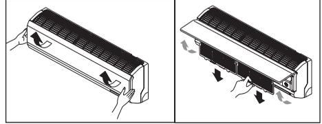
Ön paneli sağ ve sol alt köşe noktalarından ve ortadan kendinize doğru çekerek açıp anti-bakteriyel filtreleri alt kısımlarından çekerek çıkarınız. Anti-bakteriyel filtreleri vakum yada ılık su ve sabun ile temizleyiniz. (40°C ve üst sıcaklıktaki su, anti-bakteriyel filtreleri deforme edebilir.) Temizleme bitince gölgede kurutun ve tekrar anti-bakteriyel filtreleri yerine takınız.
