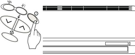
1.Eğer klimanız açık değil ise uzaktan kumandanızı,iç ünite üzerinde bulunan kontrol paneline yönlendirip, kumanda üzerindeki“açma / kapama” tuşuna basınız. Bu durumda ön paneldeki “açma / kapama” göstergesi yanacak ve klimadan uyarı sinyali gelecektir.
