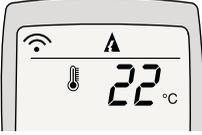
4. A.Ç.S. konumunda, odanızın ayarlayacağınız sıcaklık değerine getirilmesi için gerekli çalışma konumu (ısıtma/soğutma) oda sıcaklığının hissedilmesi suretiyle otomatik olarak ayarlanır.
